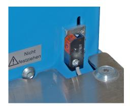
Die Fotozelle ist höhenverstellbar und wird zum automatischen Auslösen des Banderoliervorgangs genutzt.
