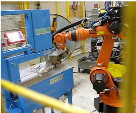
Praxisbeispiel: Automatische Roboterzuführung zur genauen Platzierung von Hacken (Dachrinnenhalterungen).
