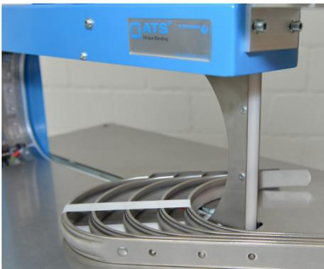
Nach dem Einführen des Rings (z. B. Schlauch) schliesst der Bogenschieber den Bandkanal, das Band wird eingeschossen, zurückgezogen und mittels Ultraschall verschweisst. Danach wird der Bogen wieder geöffnet.
