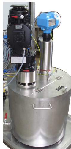
Sample: DRG-09 on opti-color tank set with automatic level control and safety switch (Beispiel: DRG-09 auf opti-color Behälter mit Füllstandsüberwachung und Sicherheitsschalter)
